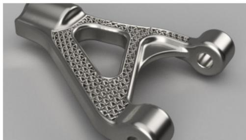
(Gauche) Une forme 'optimisée' ; (droite) une forme construite par fabrication additive.
